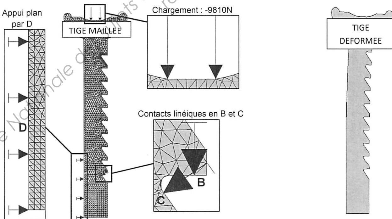
**5.2- Reporter** les valeurs des contraintes totales calculées aux points (a) et (b) sur le graphe de la figure ci-dessous. **En déduire** le tracé de l'évolution théorique de la contrainte. **Comparer** avec la courbe fournie. **Justifier** l'écart important au voisinage du point (b). **Proposer** un moyen de réduire cette valeur.
