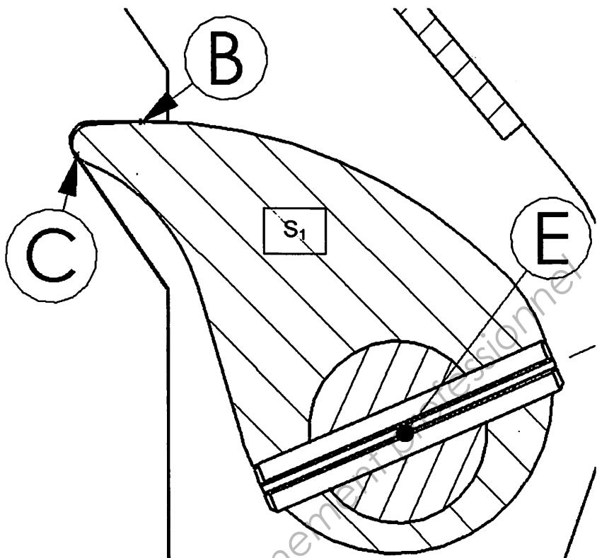
4.6- L'équivalent statique des actions en B et C étant modélisé en K par un glisseur de direction connue, représenter l'équilibre de la tige  $S_2$ , alors soumise à 3 glisseurs sachant que  $\vec{A}_{\text{charge/tige}}$  est parfaitement connue.
