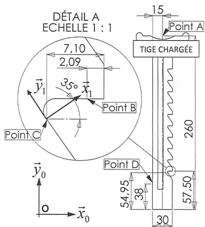
On propose de résoudre rapidement le problème en mettant en œuvre les méthodes graphiques sur le levier  $S_1$  et sur la tige  $S_2$ .
